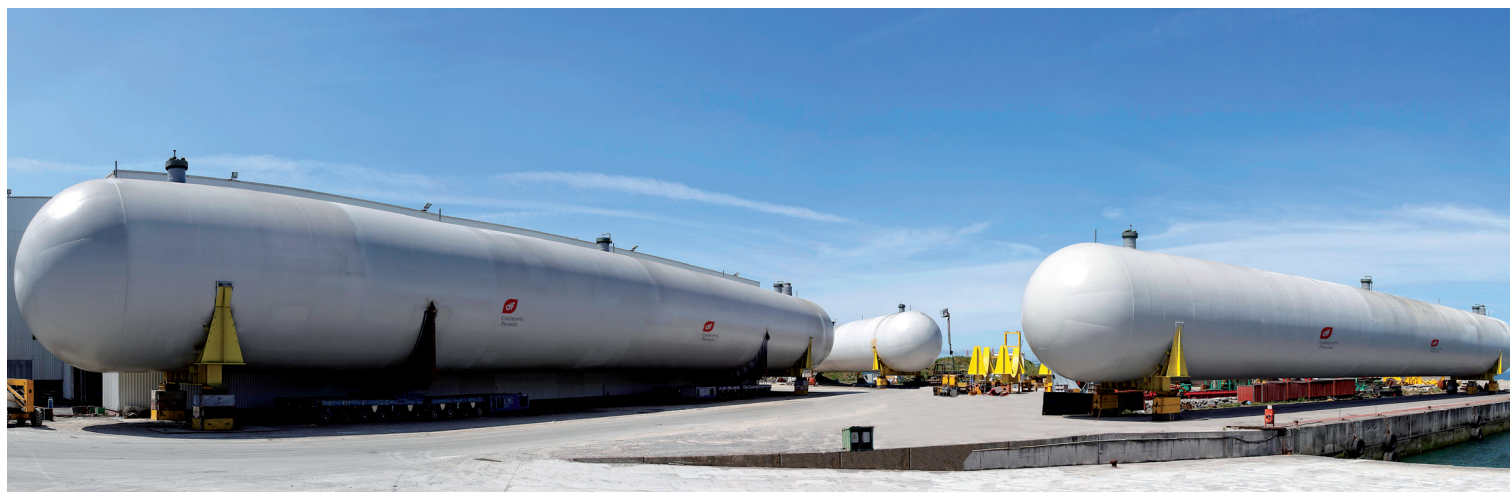
Tanques para almacenamiento de LPG.
