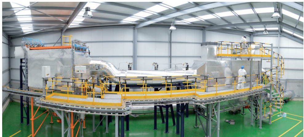
Laboratorio de Aire para probar tecnologías de filtración (6000 Nm 3 /h).
